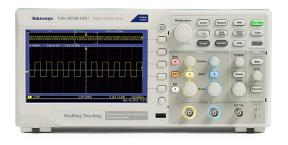
Oscilloscopio digitale a due canali 70MHz e 1.0 GS/s, da 2mV fino 5V/div, 5ns a 50s/div.
