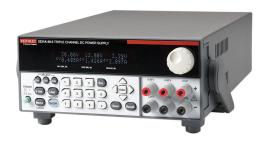
L'alimentatore ha tre uscite indipendenti con 195W di potenza complessiva. Due uscite possono essere impostate da 0 a 30V e la corrente può essere limitata da 0 a 3A. La terza uscita fornisce da 0 a 5,5V e fino a 3A.
