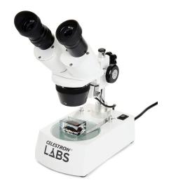
Il LABS S10-60 è un microscopio stereoscopico adatto soprattutto ad osservare circuiti elettronici, parti meccaniche, insetti ecc.
