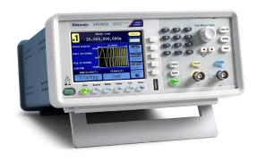
Il generatore di forme d'onda produce segnali di diverse forme e frequenze per testare circuit elettronici.
