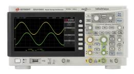
2+1 canali, 50MHz, 1GS/s 100kpts, 1mV fino a 10V/div, 5ns fino a 50s/div.
