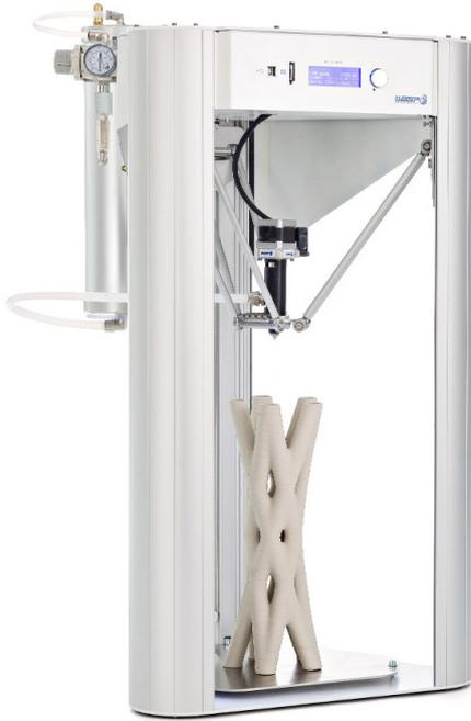
Unser Delta Wasp ist auf die Verarbeitung von Ton bzw. Porzellan umgebaut. Das "Delta Wasp Clay Kit" besteht aus einem 2l Tank und einem Extruder für Porzellan bzw. Ton Paste. Das Material wird mittels Druckluft über einen Schlauch in den Extruder gedrückt.
