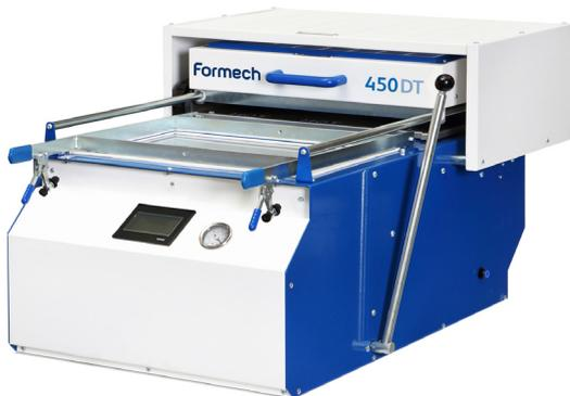
Manuelle Tiefziehmaschine zum Herstellen von Negativformen und zum Abformen von Gegenständen.
