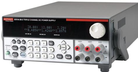
Das Labornetzteil hat drei unabhängige Ausgänge. Bei zwei Ausgängen kann die Spannung zwischen 0 und 30V eingestellt werden und der Strom zwischen 0 und 3A begrenzt werden. Der dritte Ausgang liefert 0 bis 5,5V und 0 bis 3A. Die Gesamtausgangsleistung beträgt 195W.
