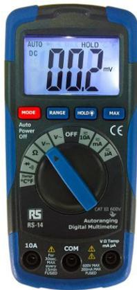
Das Meßgerät mißt den Effektivwert nur bei Gleich- und Sinusförmigen Spannungen/Strömen richtig. Bei anderen Spannungskurven wird ein angenäherter Effektivwert errechnet.
