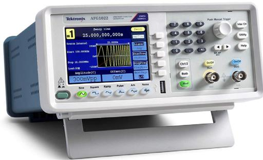
Der Funktionsgenerator produziert Signale verschiedener Formen und Frequenzen um elektronische Schaltungen zu testen.
