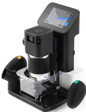
Mittels Vorlagen im SVG-Format gibt die Fräse die Bewegungsrichtung vor und gleicht Ungenauigkeiten aktiv aus. Anhand auf das Werkstück aufgeklebten Markierungen erkennt die Fräse ihre genaue Position.
